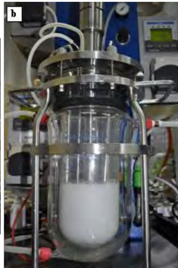
Fotografia instalacji doświadczalnej o działaniu ciągłym do otrzymywania struwitu: a) widok ogólny, b) krystalizator z wewnętrzną cyrkulacją zawiesiny typu DT MSMR.
